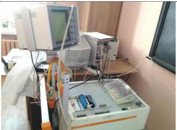
**Электрокардиограф компьютерный «поли-спектр-8».** Электрокардиограф ПОЛИ-СПЕКТР-8 - миниатюрный 12-канальный компьютерный электрокардиограф для использования при массовых ЭКГ-обследованиях.
